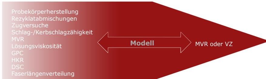
Datenerfassung → Modell → MVR- oder VZ-Messung → sichere Qualitätskontrolle
